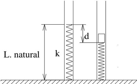
Un bloque cilíndrico de masa  $m$  se coloca sobre un resorte, sin engancharlo, de modo que puede moverse dentro de un tubo vertical liso.  $k$  es  $40 \text{ N/m}$ ,  $m$  es  $0.2 \text{ kg}$ . Use  $g \approx 10 \text{ m/s}^2$ . Si se le da una compresión inicial de  $8 \text{ cm}$ , ¿alcanzará a sobrepasar la longitud natural? ¿Hasta qué altura sube el bloque, medida desde su nivel más bajo?
