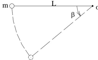
Una partícula de masa  $m$ , sujeta a una cuerda de longitud  $L$  con un extremo fijo en  $O$ , se suelta desde el reposo en una posición horizontal. Si la cuerda se rompe cuando la tensión es dos veces el peso de  $m$ , hallar el ángulo  $\beta$  en el que esto sucede y la velocidad de  $m$  en ese instante.
