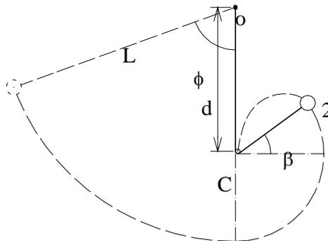
Para una distancia  $d$  determinada, hallar el ángulo  $\phi$  desde el cual debe soltarse el péndulo, para que la cuerda pierda su tensión en la posición 2 y la masa caiga con movimiento parabólico justo en  $C$ .
