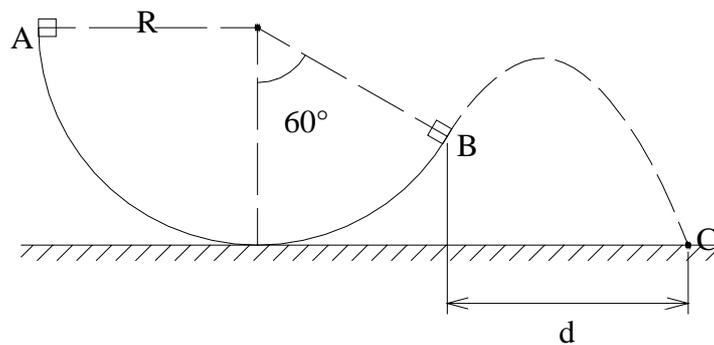
Una masa que se suelta desde A, desliza por una pista circular vertical sin fricción que termina en B ¿A qué distancia  $d$  cae al piso horizontal?
