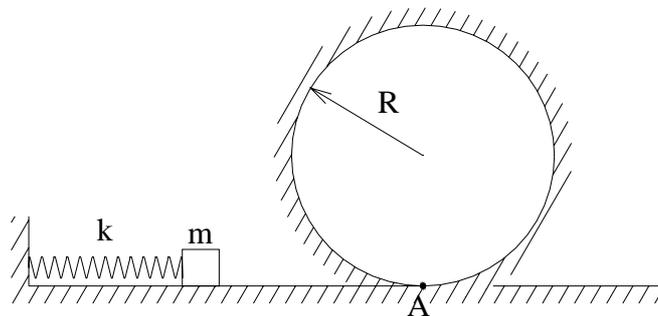
Mediante la compresión de un resorte se dispara un bloque que desliza por una pista sin fricción con un rizo o bucle vertical. Hallar la mínima velocidad necesaria en A para recorrer todo el rizo y la mínima compresión requerida en el resorte.
