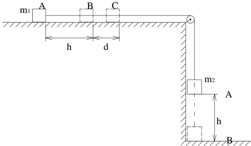
**Sugerencia :** Teorema del trabajo y la energía para  $m_1$  y para  $m_2$ , de A a B. Luego para  $m_1$ , de B a C.
