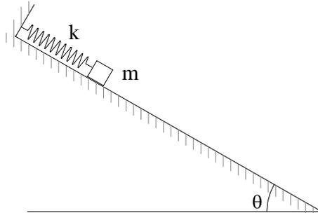
Un bloque de masa  $m$  unido a un resorte de constante  $k$ , se suelta desde la longitud natural y baja deslizando por un plano inclinado rugoso. Si el coeficiente dinámico de fricción entre el bloque y el plano es  $\mu$ , hallar la máxima elongación del resorte.
