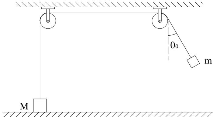
Un bloque de masa  $M$  reposa sobre una superficie horizontal y está unido por una cuerda a otro bloque de masa  $m$ , como se muestra en la figura. Hallar el mínimo ángulo  $\theta_0$  desde el cual debe soltarse  $m$ , para que  $M$  alcance justo a levantarse del piso cuando  $m$  describe su movimiento pendular.
